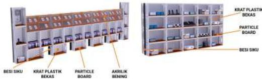
Gambar 16. Rak Display Barang Elektronik
