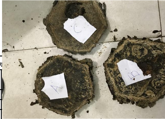
Gambar 4.7 Sampel yang Hancur Setelah Uji Kuat Tekan
