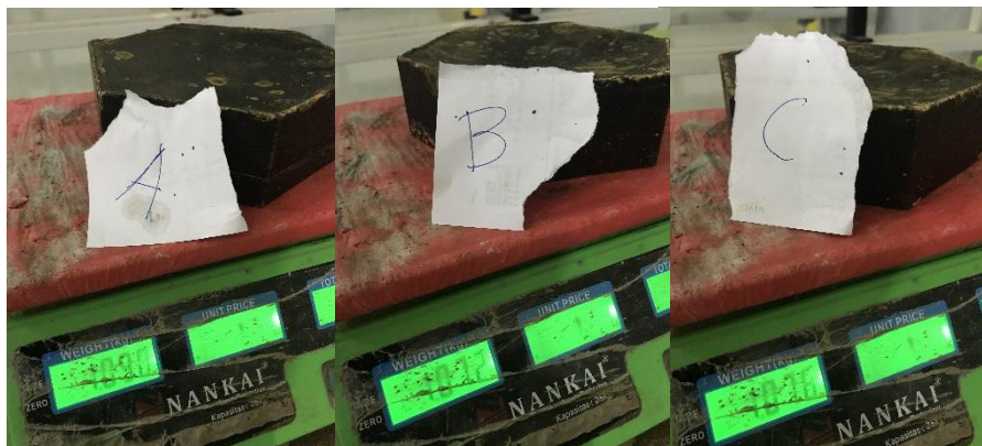
Gambar 4.5 Sampel 1-3 Sebelum Dilakukan Uji Kuat Tekan
