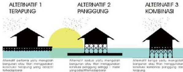
Gambar 20. Alternatif Struktur Bangunan (Sumber: Konstruksi Penulis, 2021)
