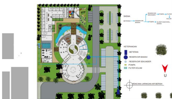
Gambar 16 Utilitas air bersih
