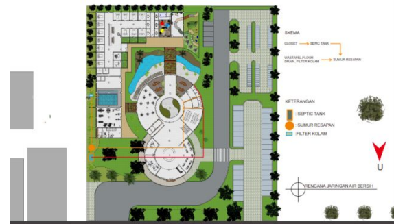
Gambar 17 Utilitas air kotor
