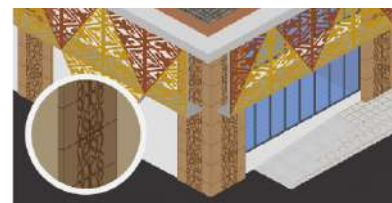
Double Cladding Pada Beberapa Bagian Fasade
